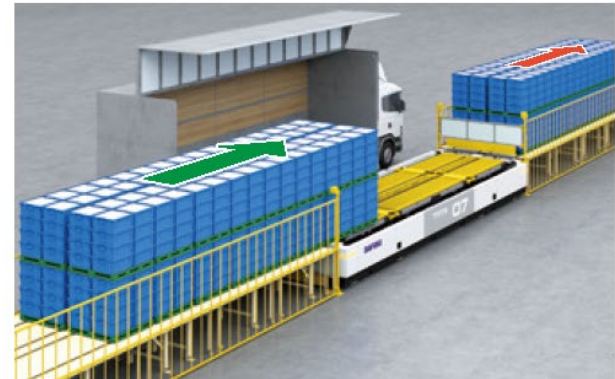
②入荷パレットをコンベヤへ払い出した後、出荷パレットを搬入。
