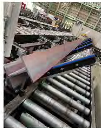
導入したH型鋼材の自動転回装置
