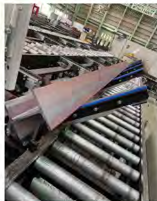
導入したH型鋼素材の自動転回装置
