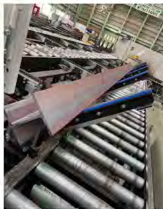
導入したH型素材の自動転回装置
