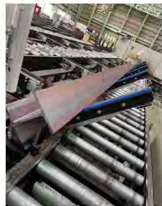
導入したH型素材の自動回転装置
