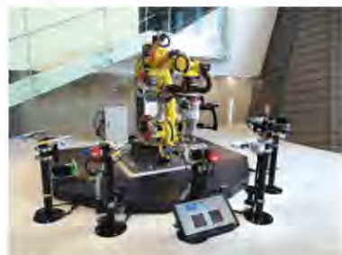
社屋1階に展示しているデモンストレーション可能な溶接ロボット
